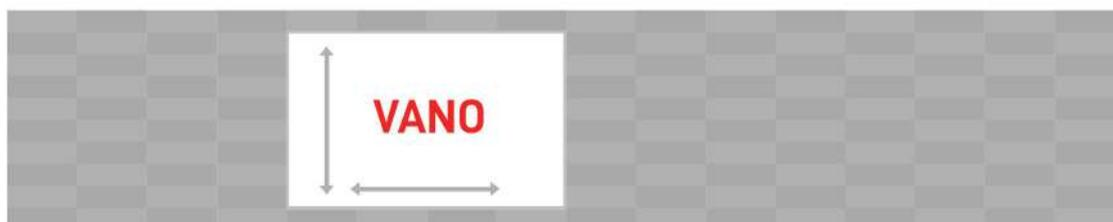
**2)** - Instalación del premarco: Colocar dentro del vano, dejar el premarco al raz del reboque interno, verificar medidas internas por posibles deformaciones. Controlar con nivel y plomo
